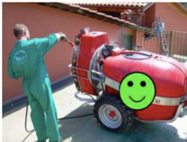
Fig. 87 – Esempio di lavaggio esterno di una irroratrice per colture arboree su area attrezzata in azienda.
